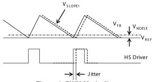
Figure 4: PWM-Mode Jitter
